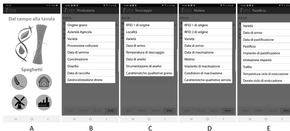
Figura 3. App per la tracciabilità della filiera frumento duro-pasta: A) Home page; B) fase di produzione; C) fase di stoccaggio; D) fase di prima trasformazione (molino); E) fase di seconda trasformazione (pastificio).
