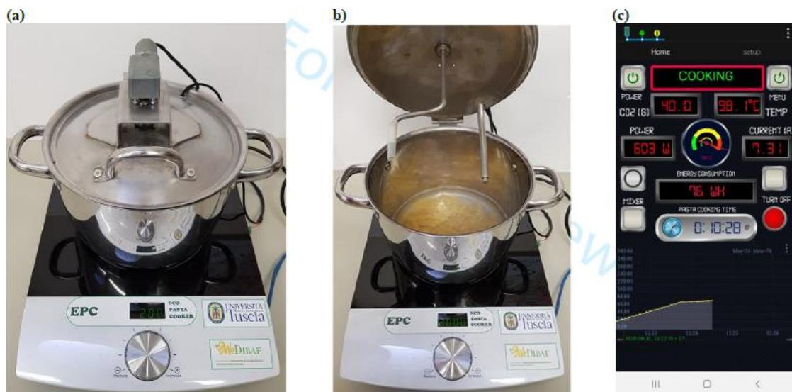
Figura 1. Immagini del cuocitore ecosostenibile all'inizio (a) ed alla fine (b) della fase di cottura della pasta con il coperchio della pentola chiuso e aperto, insieme all'applicazione installata su smartphone con i tasti funzione che monitorano la cottura della pasta (c).
